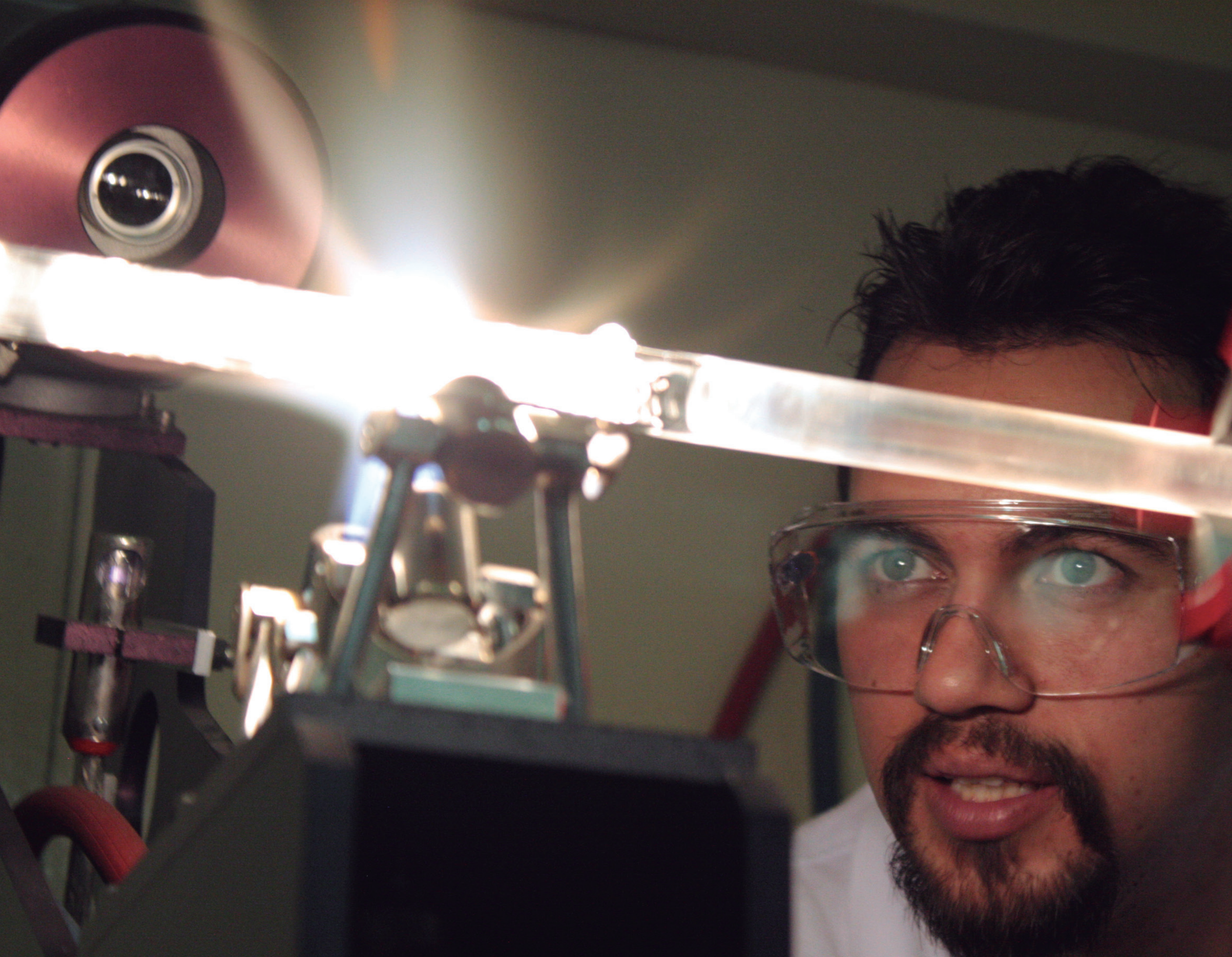
Estiramiento de fibra óptica Archivo fotográfico CIO
