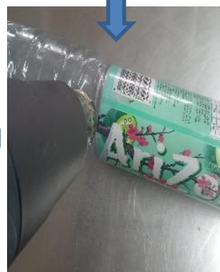
Figura 7. Unión de botellas con latas mediante el uso de calor.
